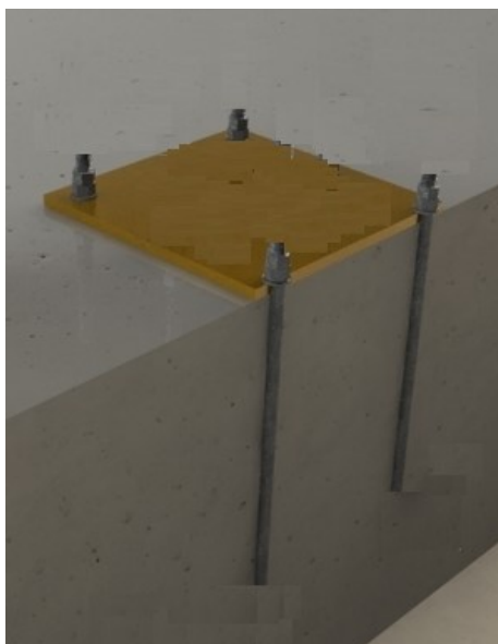
Figura 5 – Exemplo de chapa de base instalada.
